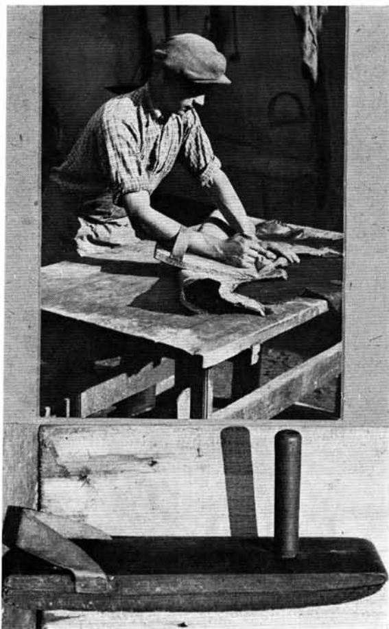
56. a) Barkázás pantoflival", b) pantofli. (Szászrégen).
