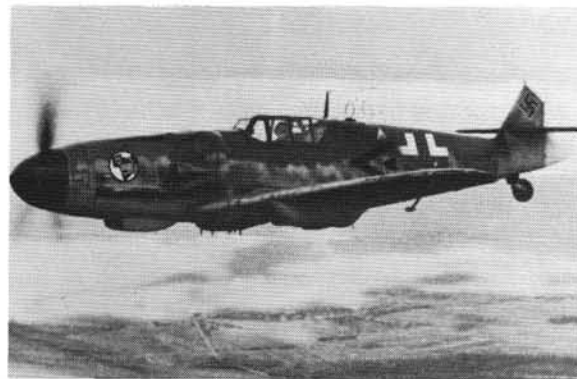
3. ábra. Német Me. 109. G—6 típusú vadászpilóta-gép
