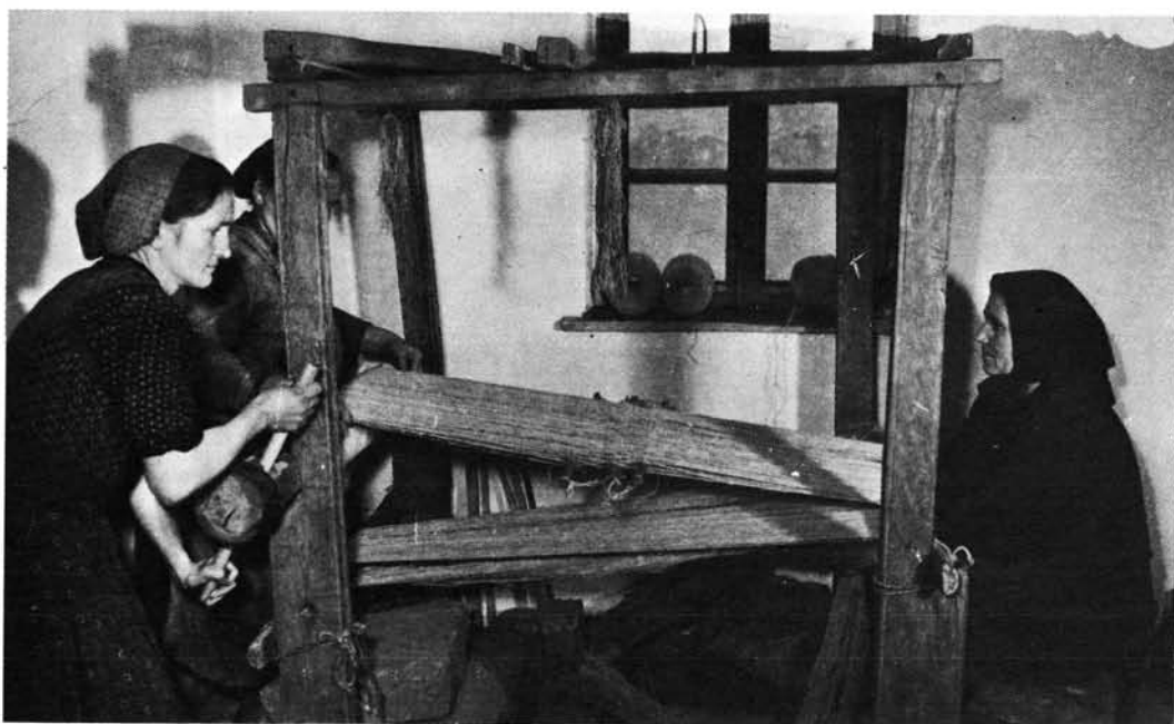
7. kép: A fonalat a szövőszékre tekerik. Jól látszik a fonál közepén a 3 elemből álló csinpálca.
