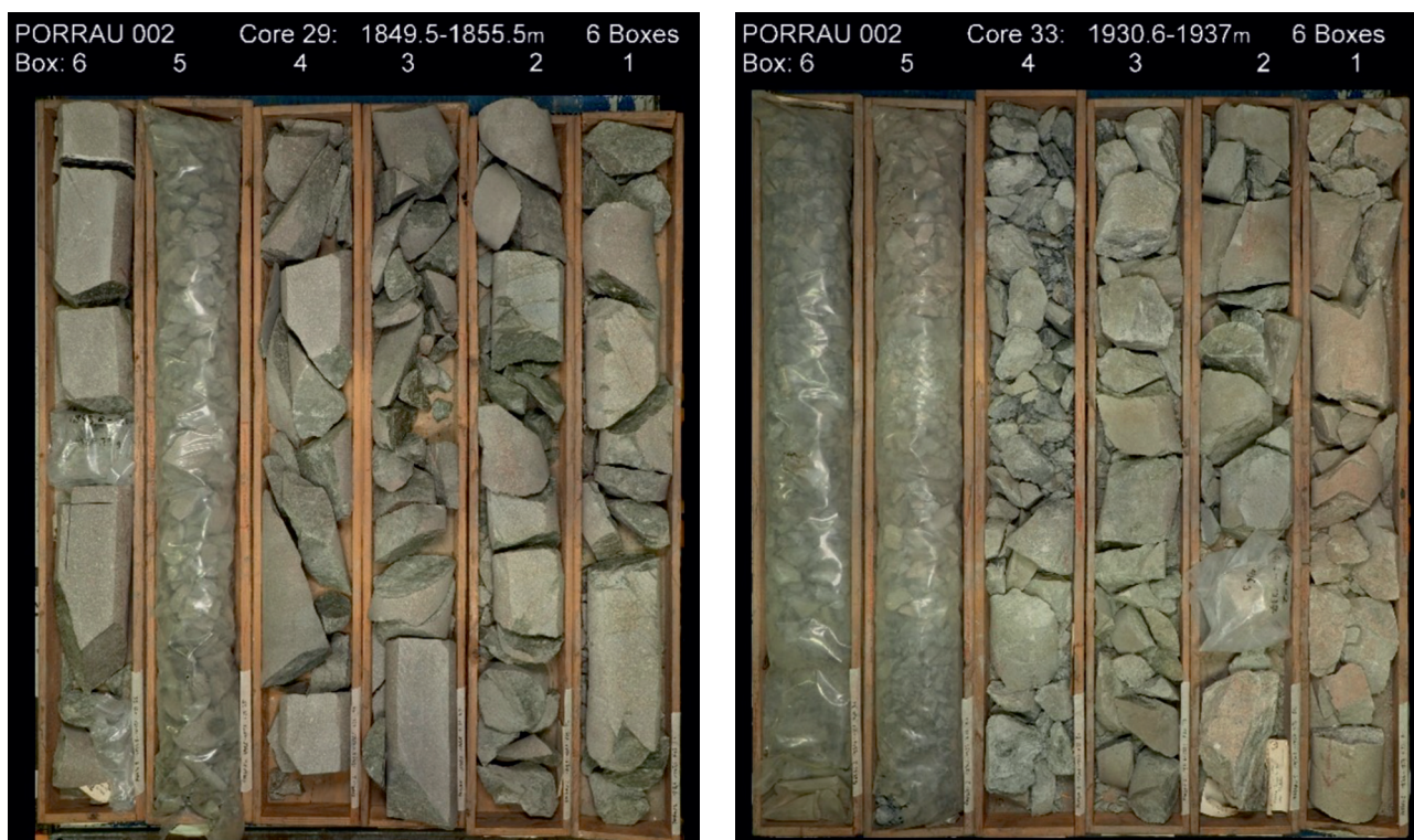
Figure 6. Cores of the metabasalt of Sample 2 (left) and dacite of Sample 5 (right) in the Porrau-2 well drilled by OMV in Lower Austria in 1960/61. Note the generally very good (>90%) recovery of the core material. The core boxes are 1 m long, the deepest part of the core at the upper right-hand corner in Box #1 6. ábra. Az OMV által 1960/61-ben Alsó-Ausztriában, a Porrau-2 kútban fűrt metabazalt (2. minta, balra) és dácit (5. minta, jobbra) magjai. A magkihozatal általában >90%-os volt. A magládák 1 m hosszúak, a mag legmélyebb része a jobb felső sarokban, az 1. dobozban található
