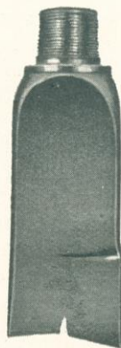
A »halfark«-nak nevezett legegyszerűbb fúró.
