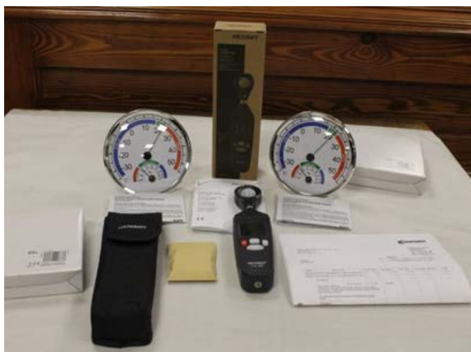
Mérőműszerek az állományvédelmi munkánkhoz. Német gyártmányú analóg hőmérséklet és légnedvességmérő (TH-101E) és Voltcraft LX-80 fénymérő készülékek segítik a mindennapi munkát, a műtárgykörnyezeti méréseket.
