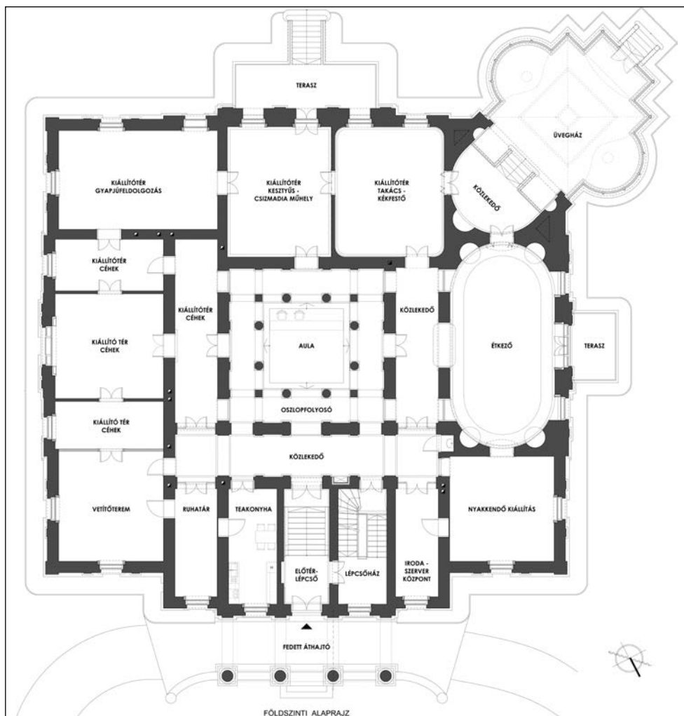
7. kép. Az átalakított villa földszinti alaprajza
