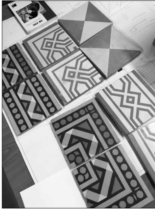
10. kép. Újragyártott padlólapok, alig észrevehető a régi és új közti különbség
