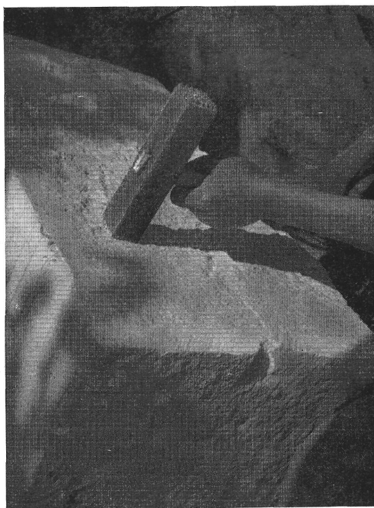
18. kép. Stokkoló kalapács használat közben L'emploi du marteau piqueur
