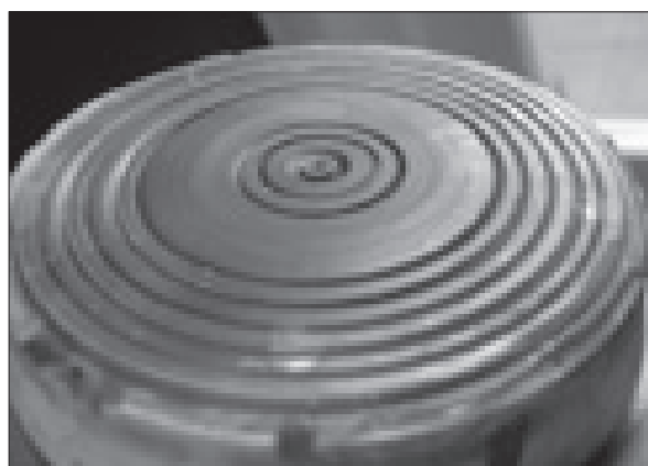
46. kép. A forgácsolás során kialakult sugárirányú bordák képződése a mag és a tengely merevségével szinte teljesen megszűnt
