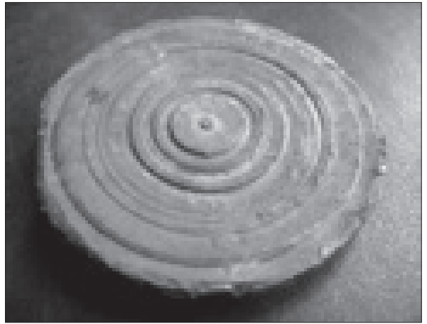
48. kép. Az első, gyúrt viaszból esztergált tükörmodell magas-öntartalmú bronzötvözetének nyers öntvénye
