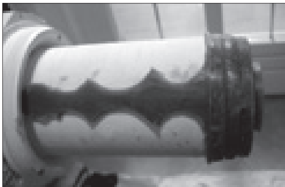
81. kép. Amennyiben a római korban egy ilyen vagy ehhez hasonló edény viaszmodelljét korongozó asztalon, faparral soványított agyagmagra felhordott viaszból dolgozták ki, abban az esetben a viaszmodell - a modellgipszes maggal szemben - alkalmas öntésre, mert átengedi a fémgőzöket.
