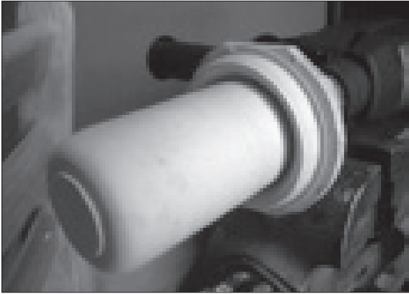
71. kép. A gipsz rudat a merítő edény belső profiljával megegyező, pozitív formára esztergáltam
