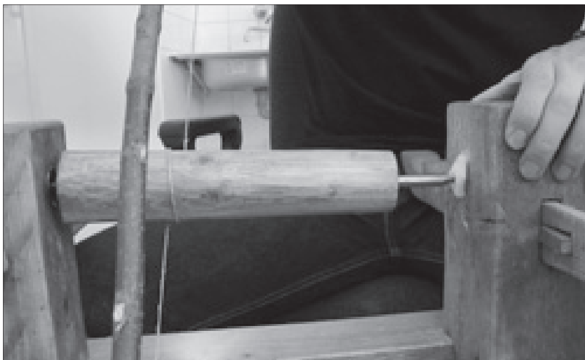
19. kép. Az eszterga az íjjal hajtott pont-kört maró fúrófejjel. (készítette: VECSEY Ádám)
