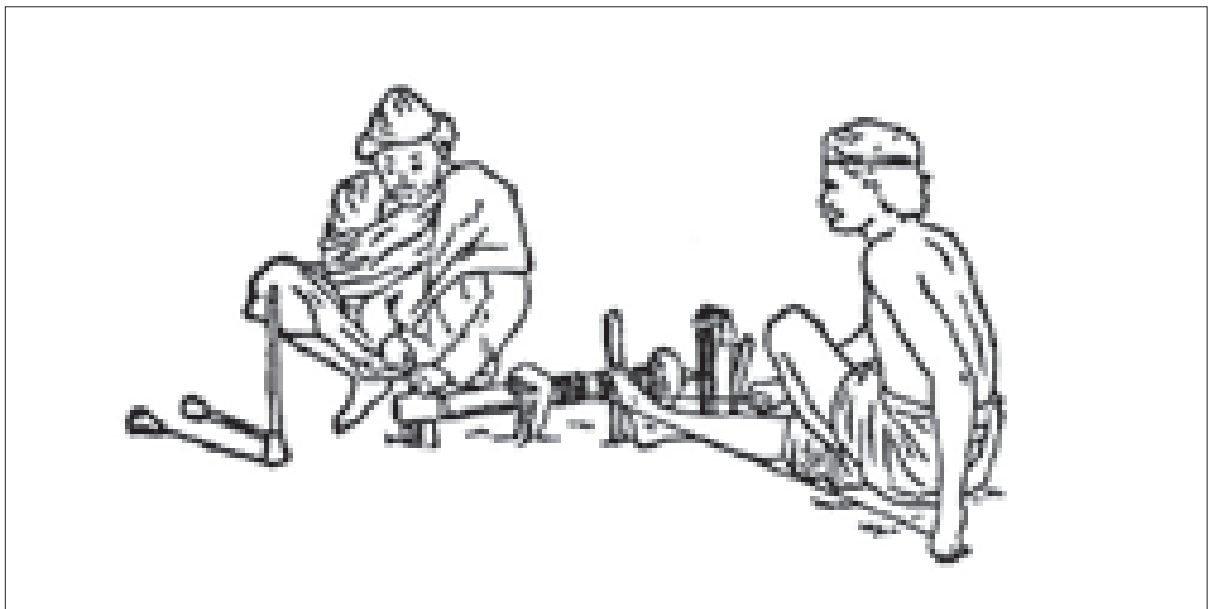
9. kép. Indiai, egy oldalon hajtott eszterga, oda-vissza forgó tengellyel. Esztergakés támasz nem látható.
