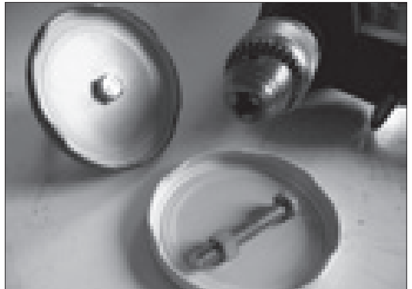
38. kép. Egy körlemez középpontjába száras csavart rögzítettem
