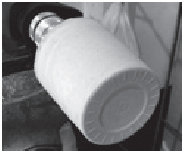
93. kép. A megkötött, de még nedves gipszet, satuval rögzített fúróba fogtam.
