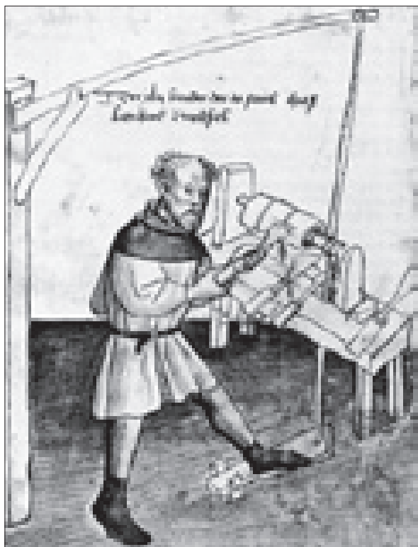
5. kép. Pedálos-póznás (pedálos-himbás) eszterga 1395-ből. Az oda-vissza forgó tengely meghajtása egy pedál és egy rugalmas pózna között kifeszített kötéllel történt. Az egyik befogó síklő-ágyas, esztergakés támasz nincs ábrázolva.
