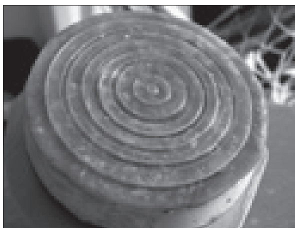
43. kép. A világos foltokban mutatkozó inhomogenitása a viasznak a gyúrás, zömítés során bezárt légbuborékokból adódott, melynek következménye volt az egyenetlen felület.
