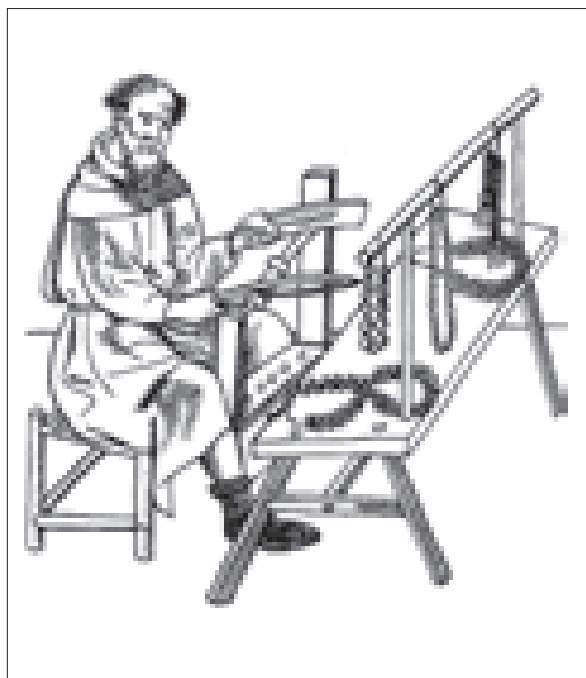
11. kép. Középkori rózsá-fűzér készítő. Íjas meghajtású. Feltehetően a két befogó közül az egyik mozgó(15.század)
