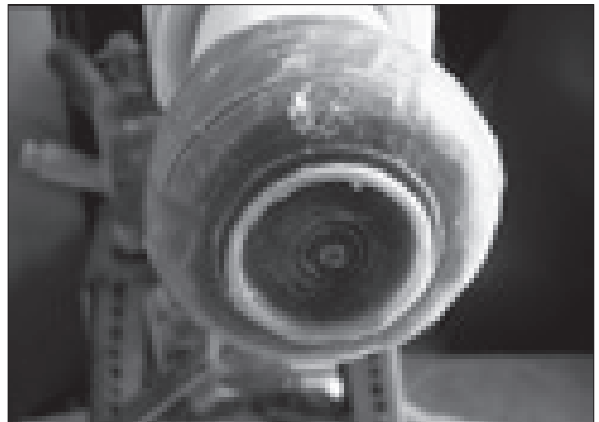
74. kép. A gipsz mag és a viasz közt hiányzó kötés következtében a modell folyamatos mozgásban volt, ami egyenetlen felületet eredményezett
