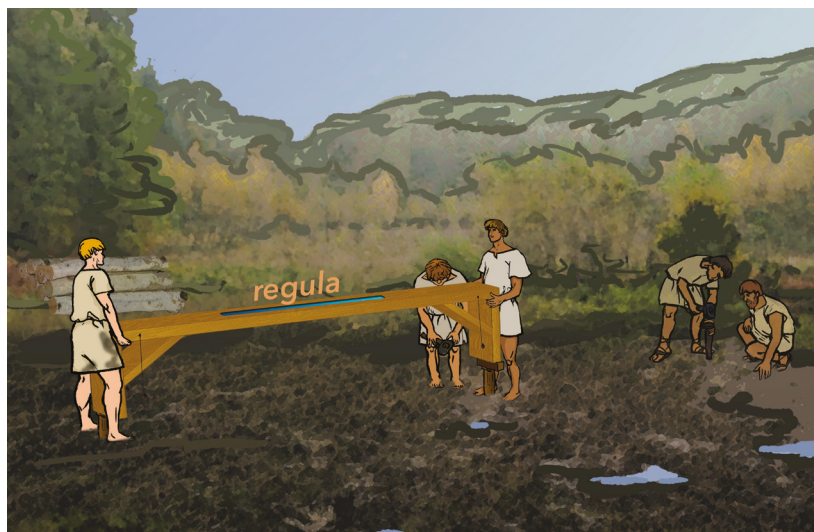
2. kép – Vízszintezés chorobateszel (Vitruvius leírása és annak Klaus Grewe szerinti értelmezése nyomán rajzolta Murakeőzy Éva)
