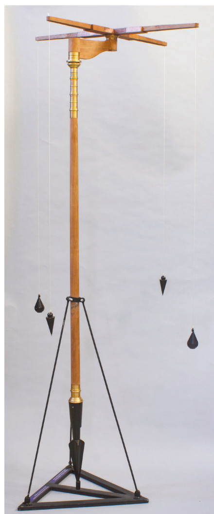
11. kép – A Pompeiben 1912-ben előkerült groma adatai alapján készített rekonstrukció (Készítette: Vecsey Ádám, fotó: Komjáthy Péter) / Fig. 11 – Reconstruction based on the details of the groma found in Pompeii in 1912 (Made by Ádám Vecsey, photo: Péter Komjáthy)
