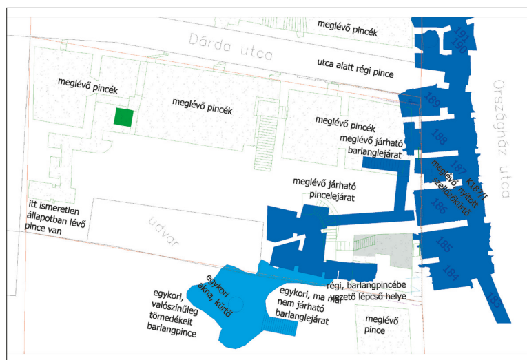
3. ábra – Az Országház utca 14. földalatti objektumainak összesített rajza (a szerző rajza) / Fig. 3 – Composite drawing of the underground objects at 14 Országház Street (drawing by the author)
