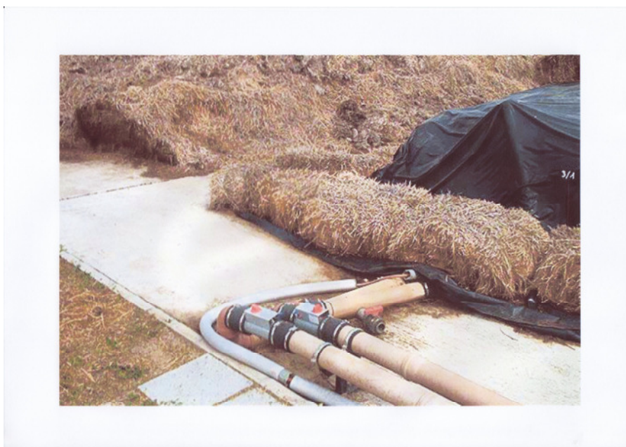
4. kép: Levegőztető csőrendszer (ATEVSZOLG Zrt., Solt)
