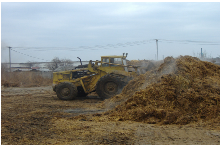
2. kép: Komposztprizma átkeverése (ATEVSZOLG Zrt., Hódmezővásárhely)
