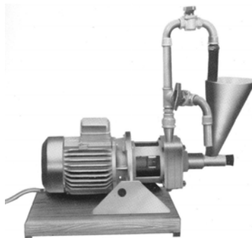
2. ábra: A mérés során alkalmazott DEZ-2L típusú laboratóriumi dezaggregátor
