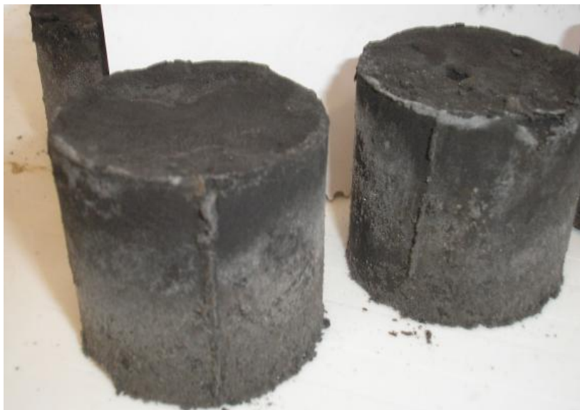
1. ábra: Geopolimer próbatestek
