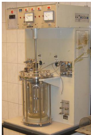
6. ábra: Braun-féle keverővel ellátott bioreaktor
