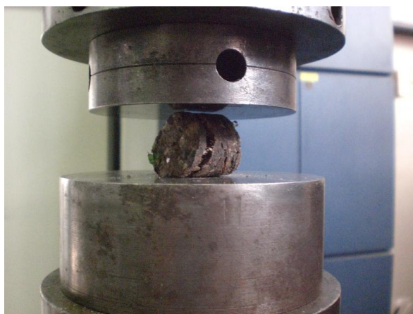
9. ábra. Tabletták közvetett húzószilárdságának meghatározása
