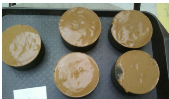
3. ábra Az alján drénezett ülepítő hengerben készült, naponta öntözött, majd kiszaluzott mintatestek
