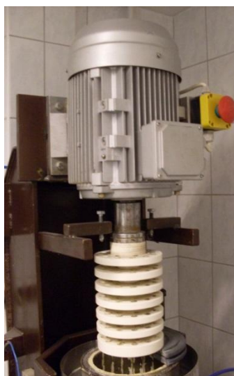
4. ábra: Kerámiabéléses, keverőmalom típusú mechanokémiai reaktor
