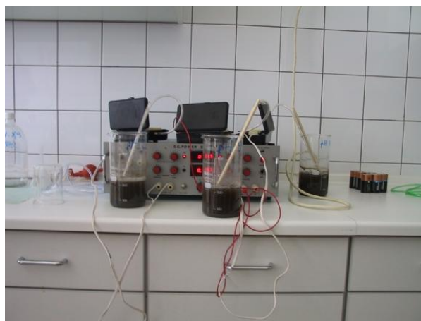
5. ábra: Az aerob biológiai szennyvíztisztítás laboratóriumi modellezése
