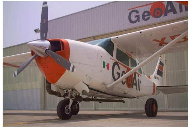
1. ábra Fotogrammetriai célokra használt repülőgép (Forrás: http://www.geoair.net/inicio.html ).
