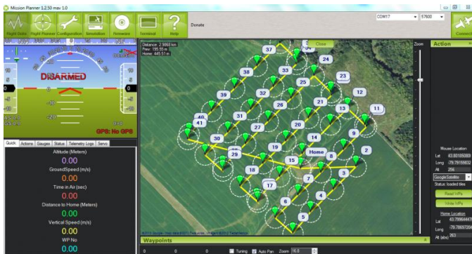
4.ábra Népszerű, pilóta nélküli repülő eszközök repülési tervét elkészítő szoftver (Forrás: http://www.aeromao.com/aeromapper_uav ).
