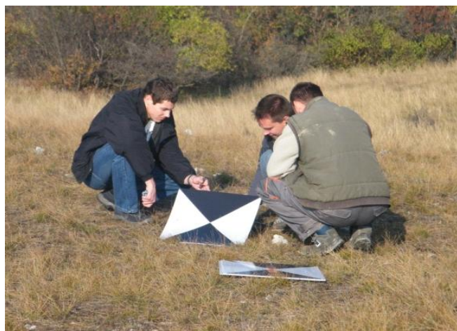
3. ábra A tesztemzőn kialakított pontjelölés
