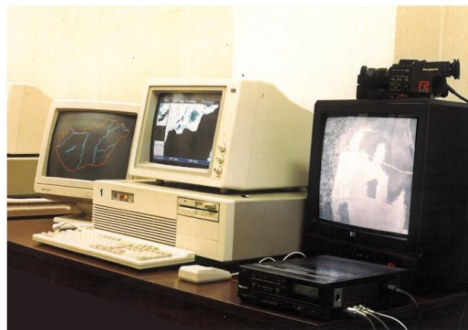
5. ábra A Video Image Processing System (VIPS) hardverkészlete
