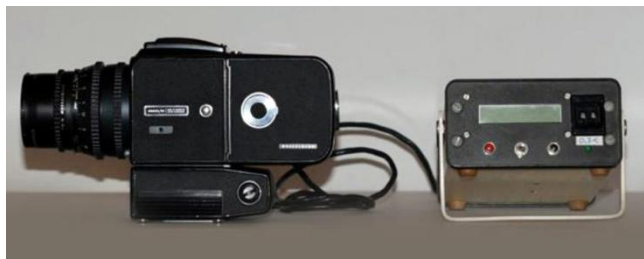
1. ábra Hasselblad 500EL/M kamera és „VITUKI” intervallométer
