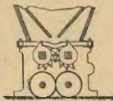
14. ábra. Kühne-féle műtrágyaszóró-malom keresztmetszete
