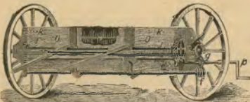
15. ábra. Schloer-féle műtrágyaszóró-gép előről.
