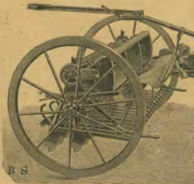
97. ábra. Sack IV. sz. toló kerekes hegyi vetőgépe kitértetve.
