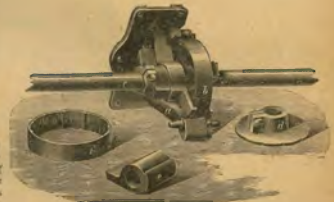
104. ábra. Kühne „Mosoni Drill” hegyi vetőgépeknek vetőkészüléke.
