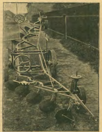
268. ábra. Beck és Gergely budapesti géppárjának két ill. 5-tesztű eké, a gazdasági lokomobilból átalakított gőztalajmivélő-géphez.
