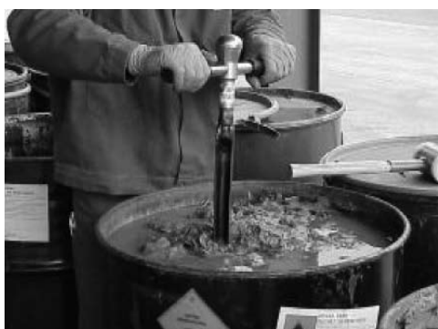
2. ábra. Tőzeg mintavevő és fűrő mintavevő iszapos és szilárd hulladékok mintavételére
