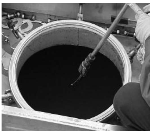
1. ábra. Gömbszelepes mintavevő cső folyékony hulladékok mintavételére
