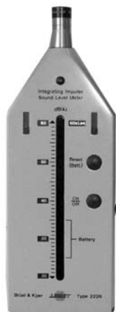
1. ábra. Brüel & Kjær 2226 integráló műszer Brüel & Kjær 2226 integrating sound level meter
