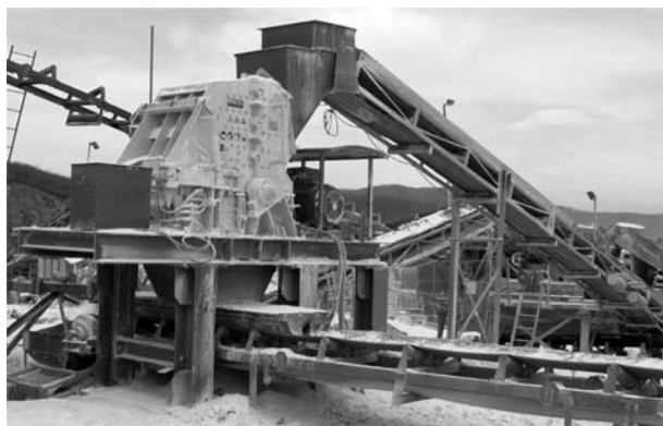
2. ábra. Az egyik vizsgált rőpítőtoró és szállítószalag-rendszere One of the investigated crushers and its belt-conveyor system
