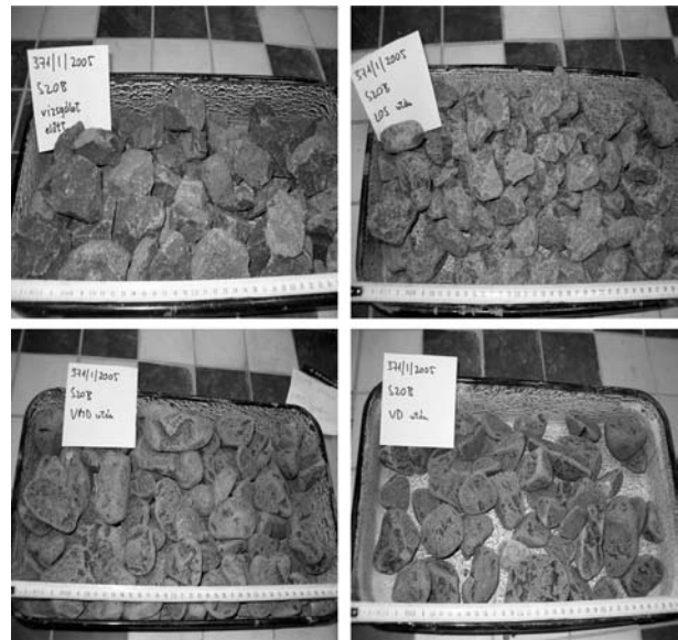
6. ábra. Andezit (Szob) vasúti ágyazati kőanyag jellemző képe vizsgálat előtt, Los Angeles-, vasúti mikro-Deval- és vizes Deval-vizsgálat után Properties of andesite aggregates (Szob) before and after Los Angeles-, micro-Deval and Deval test
