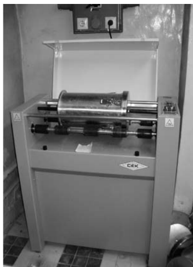
2. ábra. A BME Építőanyagok és Mérnökgeológia Tanszék Anyagvizsgáló Laboratóriumának vasúti mikro-Deval-vizsgálóberendezése Micro-Deval apparatus to test of resistance to wear
