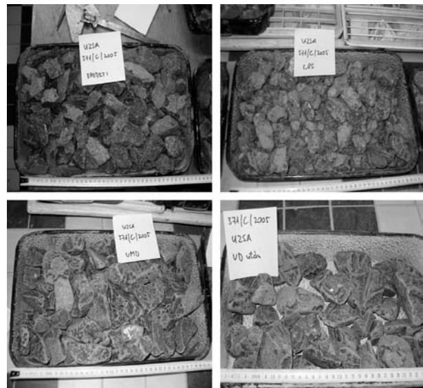
7. ábra. Bazalt (Uzsa) vasúti ágyazati kőanyag jellemző képe vizsgálat előtt, Los Angeles-, vasúti mikro-Deval- és vizes Deval-vizsgálat után Properties of basalt aggregates (Uzsa) before and after Los Angeles-, micro-Deval and Deval test
