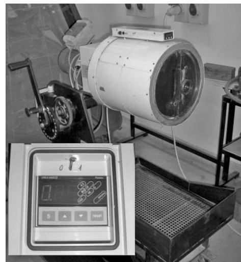
2. ábra. Bond-malom és energiaméter fényképe Fig. 2. Photo of Bond mill and energy meter
