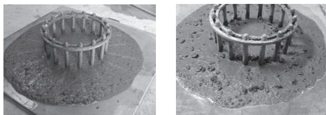
2. ábra Az 1. összetételű és a 2. összetételű [saját] beton területe Fig. 2. Cone slump of concrete: composition 1 and composition 2 (own)
