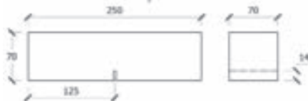
13. ábra Bemetszett, 70x70x250 mm élhosszúságú hasáb elvi kialakítása Fig. 13. Schematic shape of a notched beam, measured 70x70x250 mm
