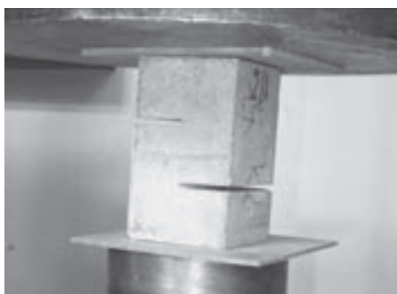
21. ábra Bemetszett, 70x70 mm alapú hasáb nyíróvizsgálata Fig. 21. Shear test of a 70x70 mm prism
