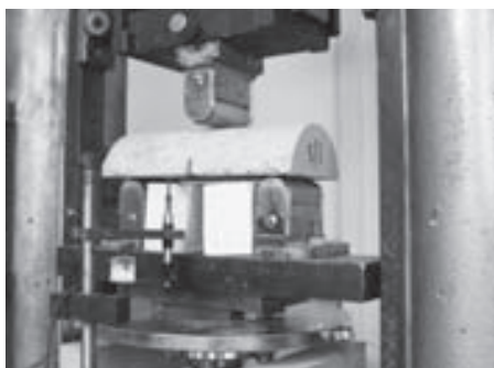
20. ábra Bemetszett, 100 mm átmérőjű, félbevágott henger hajlító-húzóvizsgálata Fig. 20. Bending test of a notched, halved cylinder, diameter 100 mm
