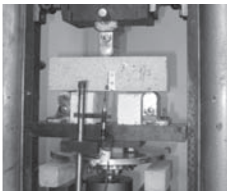
19. ábra Bemetszett, 70x70x250 mm élhosszúságú hasáb hajlító-húzóvizsgálata Fig. 19. Bending test of a notched beam, measure 70x70x250 mm
