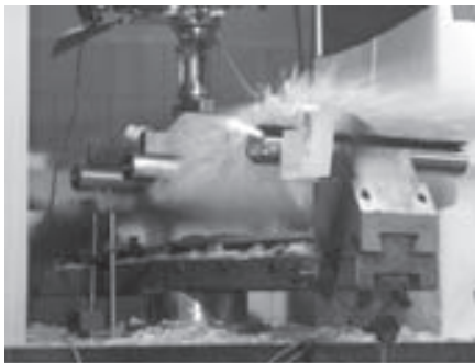
Fig. 6. Fracture of single tempered glass 6. ábra Egyrétegű edzett üveg tönkremenetele
