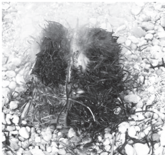
7. ábra Látható, hogy a tűzhatás a próbatestet milyen irányból érte Fig. 7. The direction of fire exposure is visible
