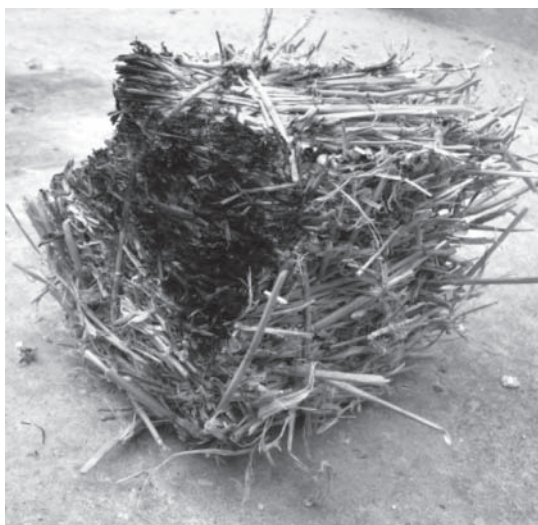
3. ábra 3 perc elteltével a tűz elaludt, a képen a szalma beégési képe látható Fig. 3. After 3 minutes the fire stopped, the charred straw bale
