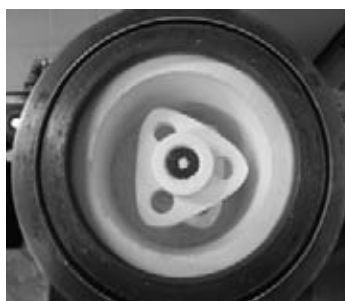
1. ábra Laboratóriumi keverőalom 0,8-1 mm-es őrlőtestekkel töltve Fig. 1. Laboratory scale stirred media mill filled with 0.8-1 mm grinding media
