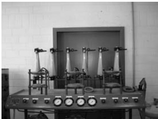
3. ábra Vízáróság vizsgáló berendezés
