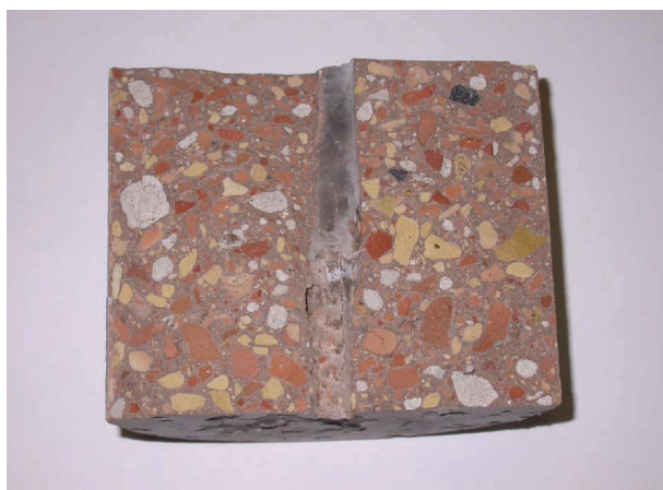
1. ábra A felhasított próbatesten jól látszik a bebetonozott és tapadásmentes acélhossz Fig. 1. Bonded and debonded lengths are clearly visible on the split specimen
