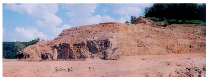
11. ábra Morzsalékos, erősen elbontott gránit, az üde gránit és a fedő gránitmurva között Fig. 11. Fractured, heavily loosened granite layer between the covering granite gravel and the intact granite mass
