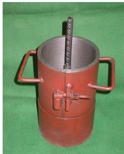
2. ábra Az alkalmazott acélsablon összeszerelt állapotban Fig. 2. Steel mould ready for concreting
