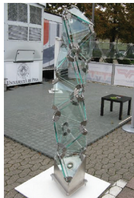
14. ábra Térbeli üveg elemekből felépülő oszlop. Fig. 14. Column made up from spatial glass elements.
