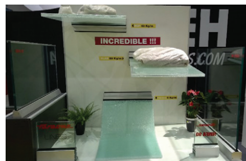
15. ábra Előtető üvegezésének tönkremenetelt követő viselkedése a különféle lamináló fóliák hatására (legfelül: SGP+40 kg/m, közepén: XLAB+80 kg/m, alul: szokványos fóliák). Fig. 15. Post fracture behaviour of glass canopy with use of different interlayer foils (in the top: SGP+40 kg/m, in the middle: XLAB+80 kg/m, in the bottom: conventional foils)
