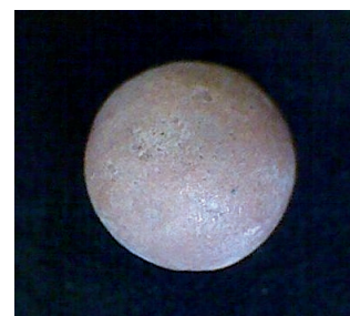
7. ábra Duzzasztott üvegekavics zárt felülettel, teherhordó könnyűbetonokhoz Fig. 7. Expanded glass aggregate with closed surface for load bearing applications
