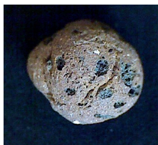
4. ábra Duzzasztott agyagkavics nyílt pórusokkal, teherhordó könnyűbetonokhoz Fig. 4. Expanded clay aggregate with open pores for load bearing applications
