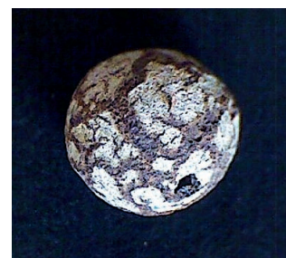
5. ábra Duzzasztott agyagkavics nyílt pórusokkal, hőszigetelő és teherhordó könnyűbetonokhoz Fig. 5. Expanded clay aggregate with open pores for thermal insulating and load bearing applications
