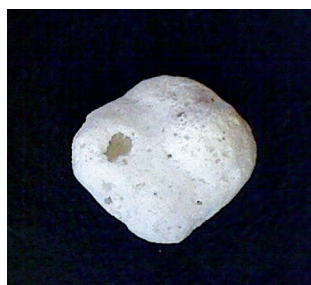
6. ábra Duzzasztott üvegekavics nyílt pórusokkal, hőszigetelő és teherhordó könnyűbetonokhoz Fig. 6. Expanded glass aggregate with open pores for thermal insulating and load bearing applications
