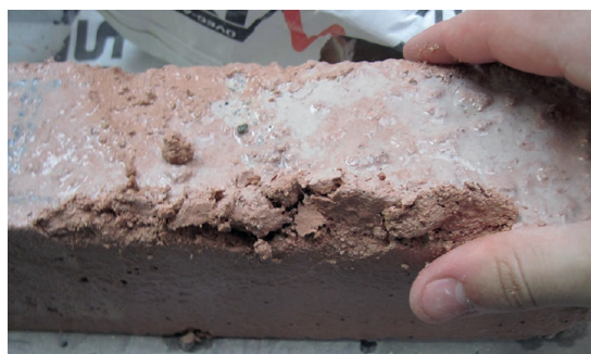
Fig. 5. White cement mixtures peeling in hand 5. ábra Fehér cementtel készült próbatest kézben mállik
