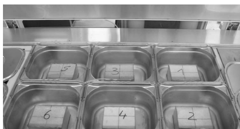
Fig. 4. Determination of the capillary suction of de-icing solution and freeze thaw test 4. ábra. Kapilláris sóoldat felszívás és fagyhámolás vizsgálata
