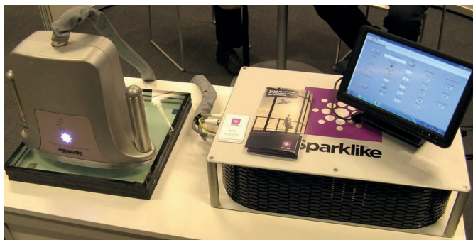
7. ábra Sparklike cég hőszigetelő üveg rétegröndjének utólagos meghatározására alkalmas készüléke
