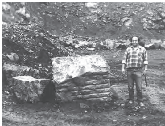
11. ábra Hasítással szabályosra formált gabbrótömb Fig. 11. Regular shape gabbro block after split processing
