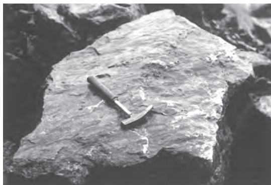
8. ábra A lerobbantott kőzethalmaz gabbrótömbjein mutatkozó vetőtűkör Fig. 8. Fault plane showing on the gabbro blocks in the debris after explosive extraction
