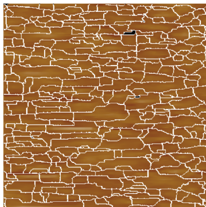
Fig. 1. AFM imaging analysis for silicon dioxide grains 1. ábra A szilícium-dioxid szemcsék AFM analízise
