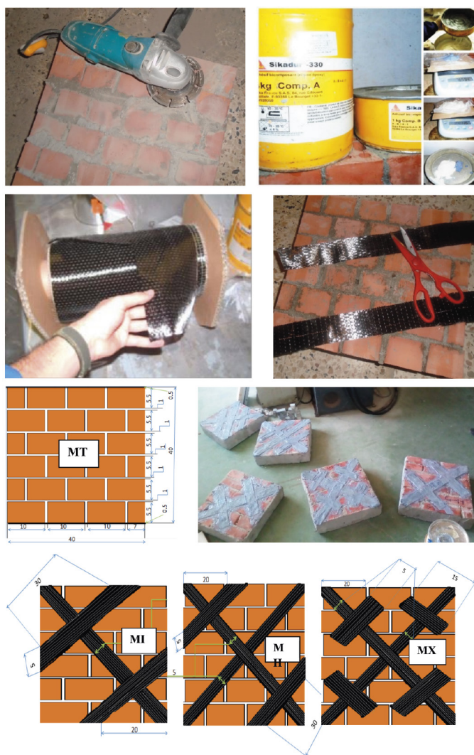
Fig. 4 Specimen preparations and configuration of reinforcing for masonry panels 4. ábra Megerősített falazat minták előkészítése
