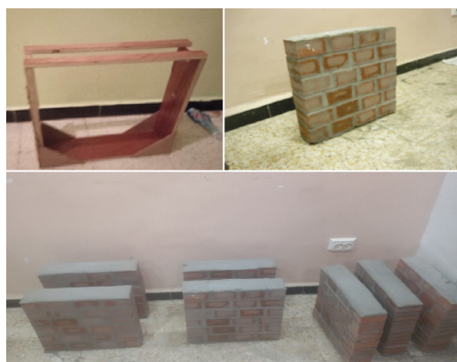
Fig. 3 Specimen preparations of unreinforced masonry panels 3. ábra Megerősítés nélküli falazat minták előkészítése
