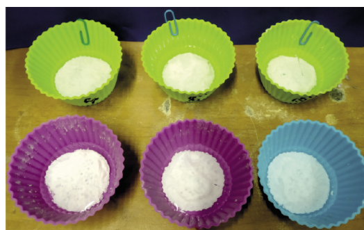
Fig. 5 Parallel solubility test for adhesives B1 and B2 5. ábra Párhuzamos oldhatósági vizsgálat a B1 és B2 jelű ragasztók esetén
