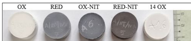
Fig. 2 The pressed samples after the pre-sintering and sintering processes 2. ábra A préselt minták az elő-szinterelési és szinterelési folyamatok után
