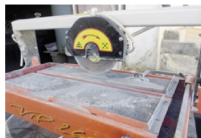
Fig. 2 Cutting samples into cubes ( 4 \times 4 \times 4 ) cm 3 2. ábra Kocka próbatestek ( 4 \times 4 \times 4 ) cm 3 -sé vágása
