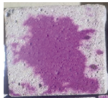
Fig. 7 MSD mortar after 56th days in accelerated carbonation chamber 7. ábra Az MSD habarcs 56 napnyi gyorsított karbonátosodási kamrában töltött idő után
