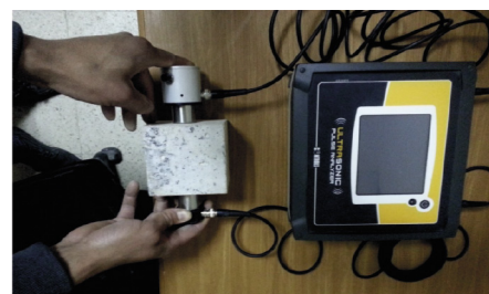
Fig. 7 Transit time measurement with ultrasonic device 7. ábra Átfutási idő mérése ultrahangos eszközzel
