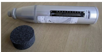
Fig. 4 Rebound Hammer type N model C 181 4. ábra C 181 típusú N típusú Schmidt kalapács C 181
