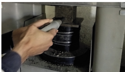
Fig. 5 Measurement of the rebound index with the Rebound Hammer 5. ábra A visszapattanási index mérése a Schmidt kalapáccsal
