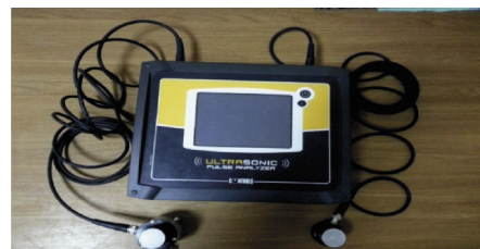
Fig. 6 The used device of Ultrasonic Pulse Velocity 6. ábra Az ultrahangos impulzusebbség mérésére használt eszköz
