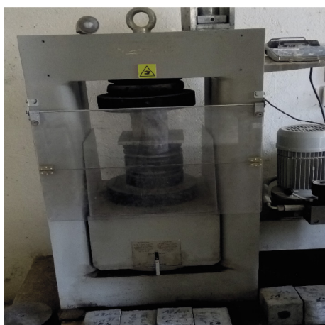
Fig. 9 Crushing of the cubic samples 9. ábra A kocka alakú minták törése
