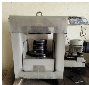
Fig. 8 Hydraulic press with the capacity of 3000 kN 8. ábra 3000 kN kapacitású hidraulikus prés
