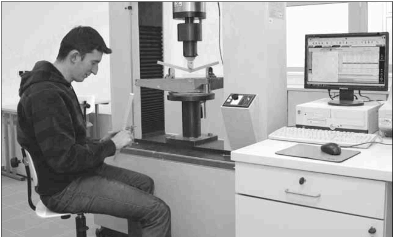
2. kép Faanyag mechanikai tulajdonságainak vizsgálata
