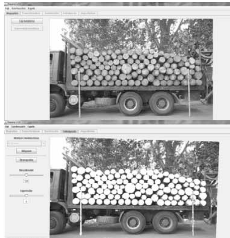
1. ábra Nyers kamerakép beolvasása a sarangelemző programmal és a képfeldolgozási eredmény automata algoritmus segítségével
