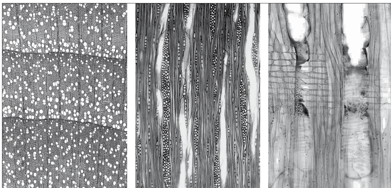
1. ábra A zselnicemeggy kereszt-, húr- és sugármetszete (fénymikroszkóp) (Schoch et al. 2004)
