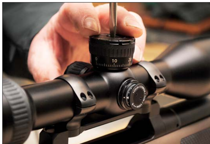
A kiválasztott korrekciós gyűrű felszerelése a toronyra
