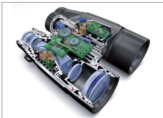
A Zeiss Victory 8x56 RF keresőtávcső szerkezete
