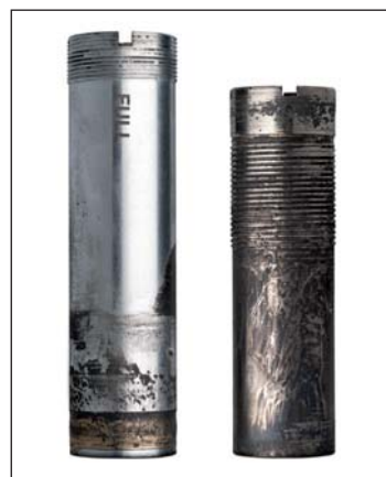
Az új és a régi choke közötti különbség 500 lövés után
