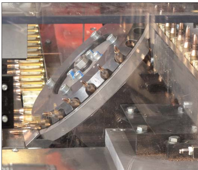
A mag bepréselése a sárgaréz hüvelybe
