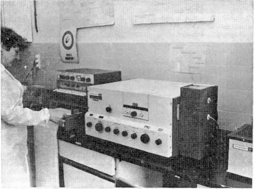
5. ábra: Perkin-Elmer spektrofluoriméter fluoreszcencia szinképek felvételére
