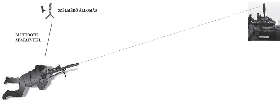
4. ábra: A tüzelőállás közelében telepített mérőállomás Forrás: a szerző szerkesztése
